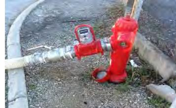
**9. Fermer lentement l'hydrant puis démonter l'appareil de mesure.**
