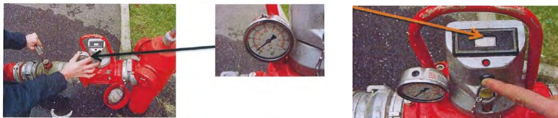
**8. Poursuivre l'ouverture de la vanne de l'appareil de mesure**
